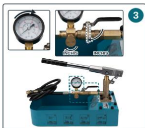
Fig. 3 - Robinet inchis, verificarea presiunii
