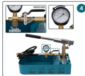
Fig. 4 - Vidage: vanne et vanne ouvertes
