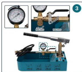
Fig. 3 - Vanne fermée, contrôle de pression
